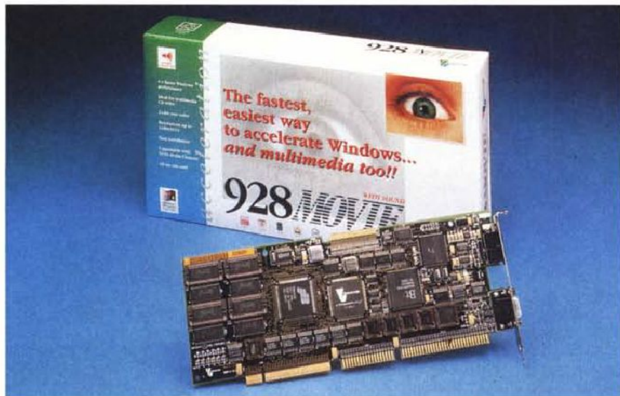
VideoLogic 928 Movie, scheda combinata acceleratrice Windows (S3 928), gestione multimediale VESA Media Channel e capacità di riproduzione video digitale (file AVI) a tutto schermo.
